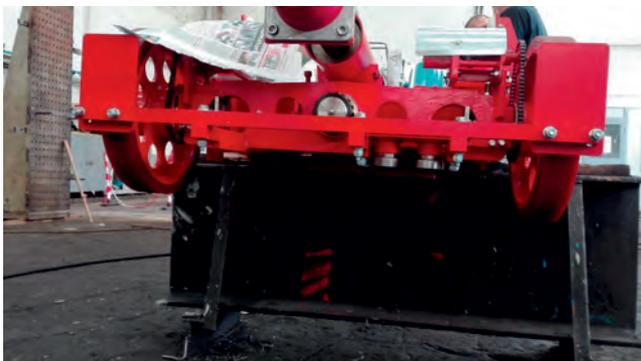
Carrello, parte anteriore: bilanciere con le due ruote, respingente, 2 dinamo azionate dalle ruote (dx e sin.), in celeste s'intravede uno dei martinetti soll. pianale. Sotto, 2 dei 4 rulli di guida sulla monorotaia.
